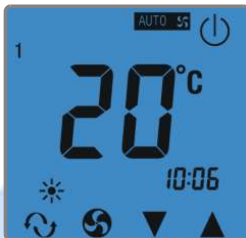
Ekran 5. Aktywacja nagrzewnicy kanałowej
