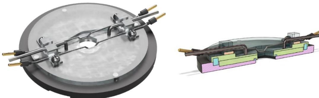
Rycina 6. Konstrukcja komory do przyżyciowych obserwacji komórek przy użyciu technik mikroskopowych i jej przekrój podłużny.
